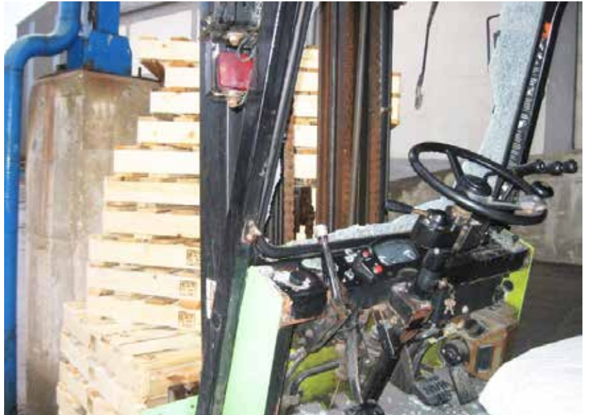
Resim 8 – Forklift operatörünün başını çarpması sonucu kırılan forkliftin camı.
